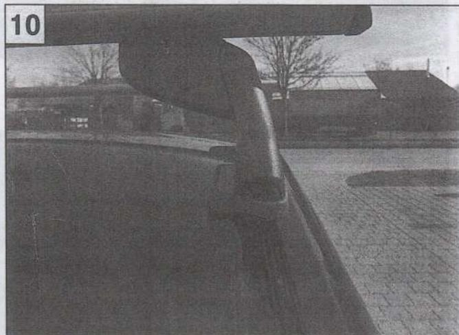
Dachträger (laut Anleitung) aufsetzen und montieren.
