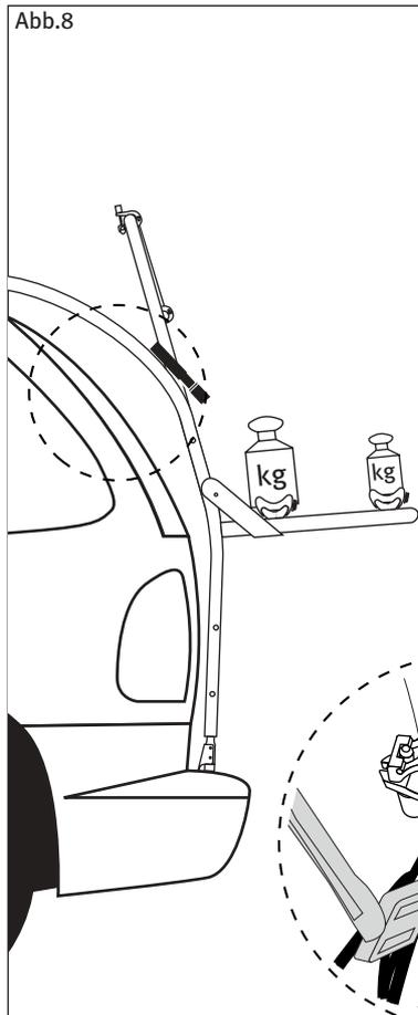
7. Wenn kein Fahrrad transportiert wird, Ausleger hochklappen und mit dem Spanngurt am Basisrahmen sichern.
