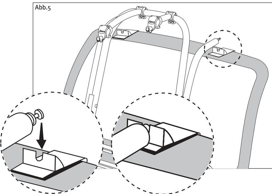
3. Montagebereiche an der Heckklappe, vor jeder Verwendung, ohne chemische Mittel reinigen (Lackschäden vermeiden).
